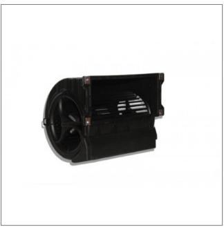
Le ventilateur centrifuge à action double aspiration avec enveloppe **D3G146-LU03-01 ebmpapst** est équipé d'une turbine en matière plastique PA. La surface du rotor est galvanisée. Grâce à la technologie Greentech, le démarrage du ventilateur **D3G146-LU03-01 ebmpapst** à économie d'énergie se fait progressivement.
