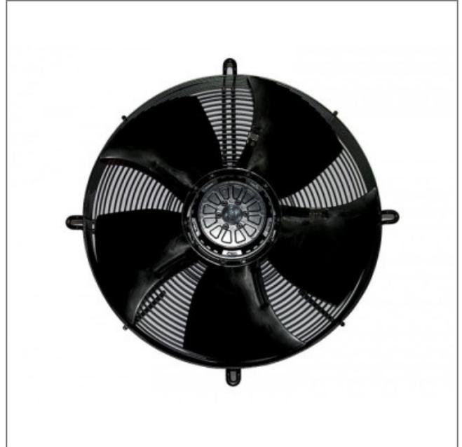
Ce ventilateur hélicoïde sur grille **S4D500-AM01-03 ebmpapst** possède une moto-hélice 5 pâles en tôle d'acier pressée, pulvérisée en plastique PP, une grille de protection en acier revêtu de plastique noir pour bec court et rotor peint en noir. Sa construction esthétique et compacte donne un meilleur rendement.
