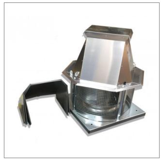
Extracteur de toiture 400°/2h **RFV-400-6M SODECA**, roue à aubes courbées vers l'arrière en tôle d'acier galvanisée avec sortie verticale, capot en aluminium.
