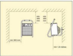
Fig. 1: Distances de sécurité pour une installation fixe.
