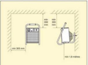
Fig. 1. Distances de sécurité pour une installation fixe.
