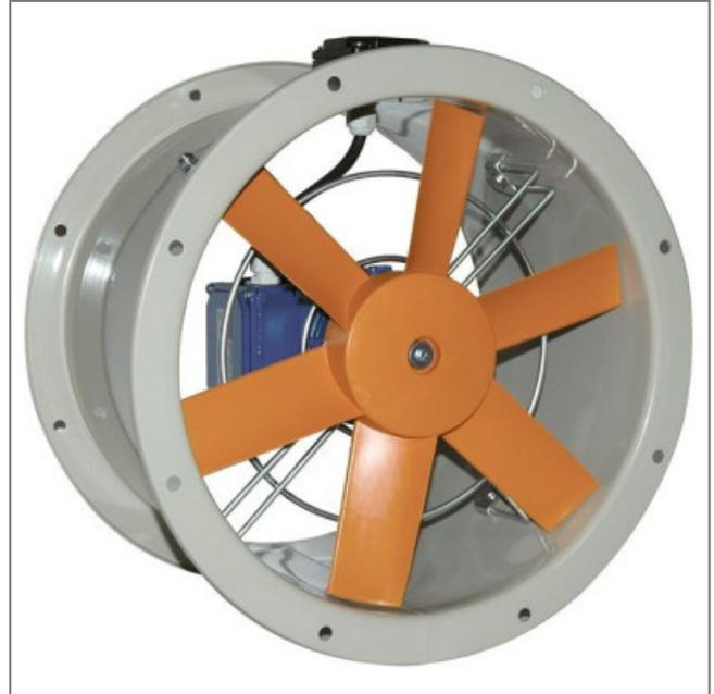
Côte d'encombrement :  $\text{ØA} = 425\text{mm}$ ,  $\text{ØB} = 395\text{mm}$ ,  $\text{ØD} = 355\text{mm}$ ,  $E = 230\text{mm}$ ,  $\text{ØJ} = 10\text{mm}$ ,  $N = 8 \times 45^\circ$
