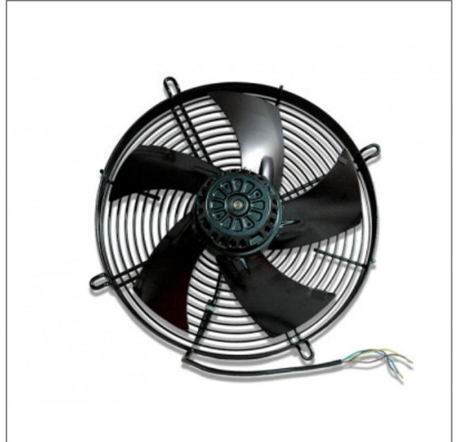
Le ventilateur hélicoïde sur grille **S2E300-AP02-30** avec moteur à rotor extérieur noir possède une roue à 5 pales faucilles en tôle d'acier galvanisé peint en noir. Il est muni d'une grille de protection pour pavillon court en acier phosphaté et plastifié noir.
