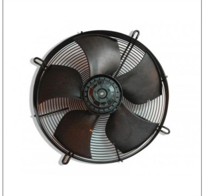
Le ventilateur hélicoïde sur grille **S4E450-AU03-01 ebmpapst** est pourvu d'une moto-hélice 5 pâles faucilles en tôle d'acier ronde sertie, surmoulée plastique PP, d'une grille de protection en acier phosphaté et plastifié noir pour pavillon court et d'un rotor peint en noir.
