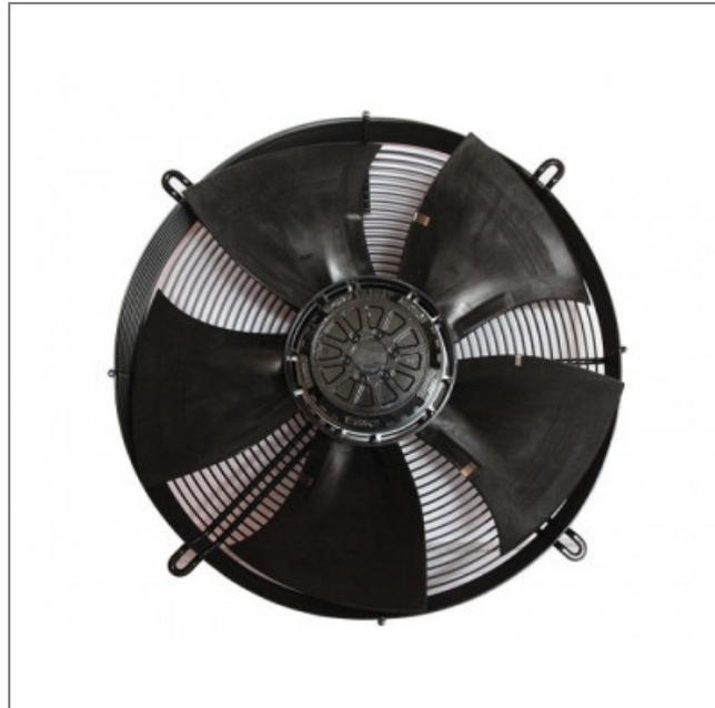
Une moto-hélice 5 pâles faucilles en tôle d'acier pressée pulvérisée en plastique PP avec grille de protection en acier plastifié noir et un rotor peint en noir sont montés sur ce ventilateur hélicoïde sur grille **S4D500-AM03-02 ebmpapst**.
