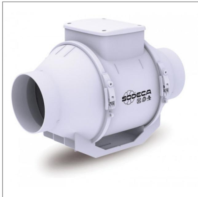
De petite dimension, le ventilateur extracteur en ligne de conduits circulaires **SODECA NEOLINEO 200/V** possède un moteur 2 à vitesses réglables. Il est muni d'un corps démontable. Le moteur et la gaine du ventilateur sont en matière plastique blanc auto - extinguible VO.
