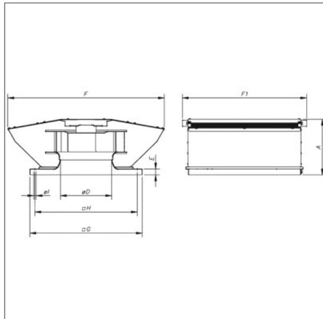
Extracteurs centrifuges pour toiture **CRF-250-4T** **SODECA** de faible niveau sonore, avec moteur à rotor externe et grille de protection contre les oiseaux.
