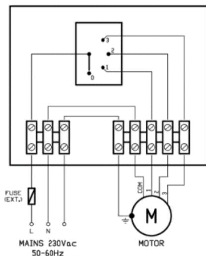
Fig.1/Pic.1 Schema delle connessioni - Wiring diagram
