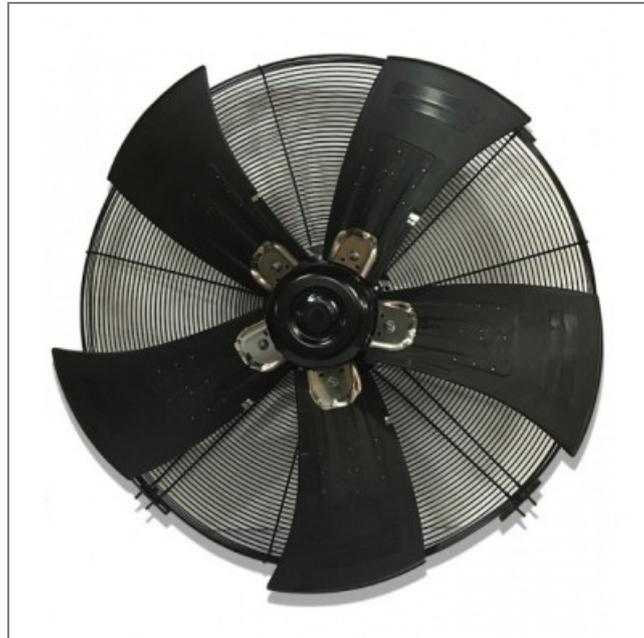
Le ventilateur axial EC sur grille **S3G910-AV02-01 ebmpapst** possède une moto-hélice 5 pales faucilles insert en tôle d'aluminium, surmoulée avec du plastique PP et la surface du rotor est peinte en noir et une grille. Il garantit d'excellents rendements.
